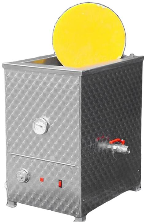
Dieser Behälter hat eine Ölbadheizung und ist stufenlos von 45°C - 130°C regelbar.
