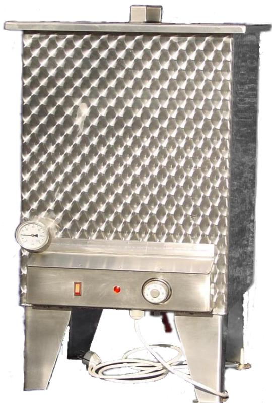
Im Wasserauftaubehälter wird direkt ein Wasserbad beheizt. Dadurch ist der Honig schonend und schnell aufgetaut.
